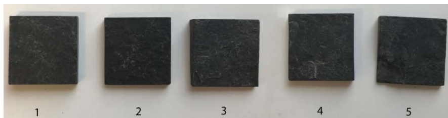
Rys.1. Próbkki łupka o wymiarach 40x40x8 mm przed badaniem odporności na szok termiczny
