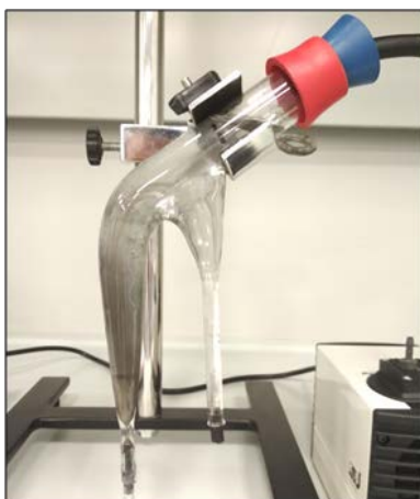
Rys. 2. Aparatura do flotacji próżniowej wykorzystująca flotownik Hallimonda
