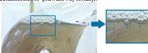
Rys 7. Utworzone agregaty ziarno-pęcherzyk gazowy podczas flotacji we flotowniku 2 w obecności 0,05% MIBC
