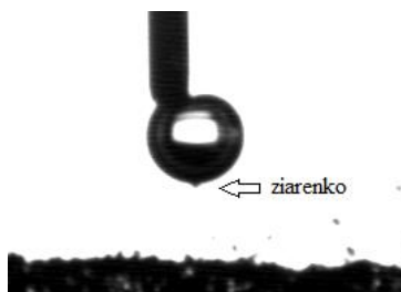
Rys. 2. Brak przyczepności ziarn chalkozynu do pęcherzyka powietrza w wody destylowanej
