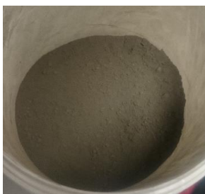
Rys. 3. Łupek miedzionośny rozdrobniony do wymiaru ziarn < 0,1 mm. Widoczny jest czarno-szary kolor łupka
