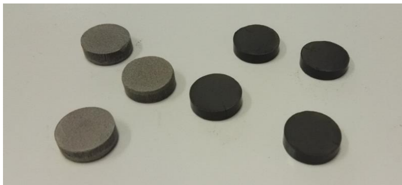
Rys. 1. Pastylki sporządzone z badanych łupków przez ściskanie ziarn -100 \mu m w prasie hydraulicznej. Łupek S – jasne pastylki, łupek P – ciemne pastylki
