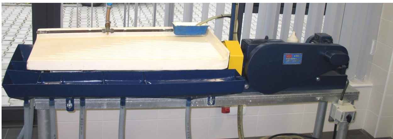
Rys. 2. Stół koncentracyjny z płytą roboczą o powierzchni 0,45 m 2 w Laboratorium Zakładu Przeróbki Kopalni i Odpadów
