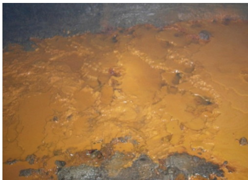
Rycina 7. Osad denny bogaty w wodorotlenek żelaza, powstały przy udziale bakterii utleniających, zredukowane związki żelaza (kopalnia miedzi Lubin)
